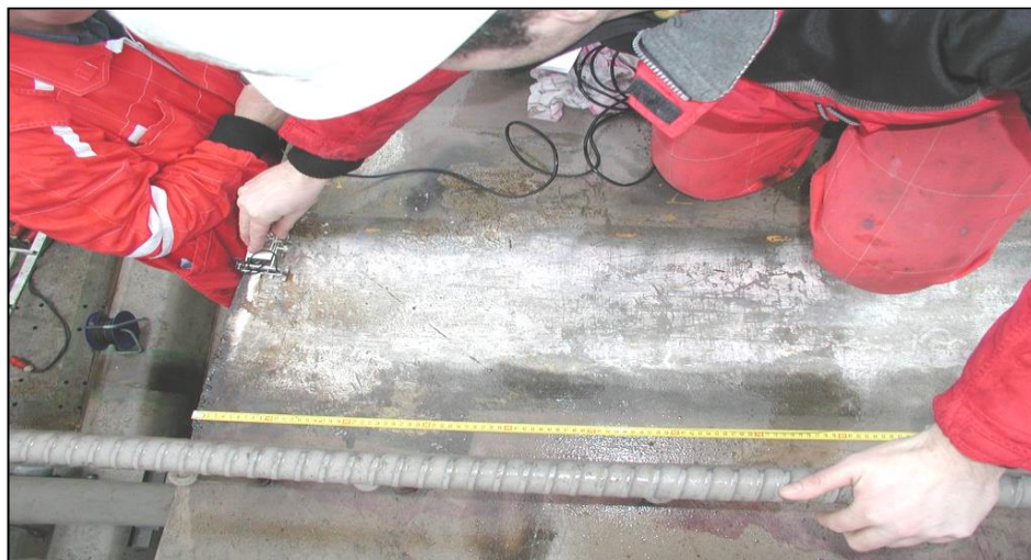
Inspekce svarového spoje
